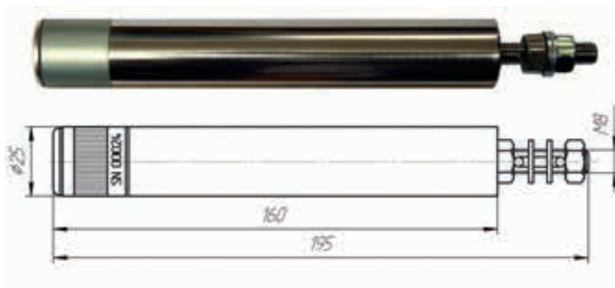
Рис. 4. Логгер цифровых датчиков (ЛЦД-1/100). Размеры указаны в миллиметрах
