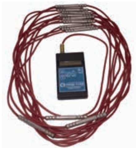
Рис. 1. Термокоса (МЦДТ 0922) с контроллером (ПКЦД-1/100)
