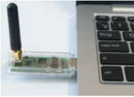
Рис. 8. Радиомодем (USB-RM) для передачи результатов измерений температуры на компьютер
